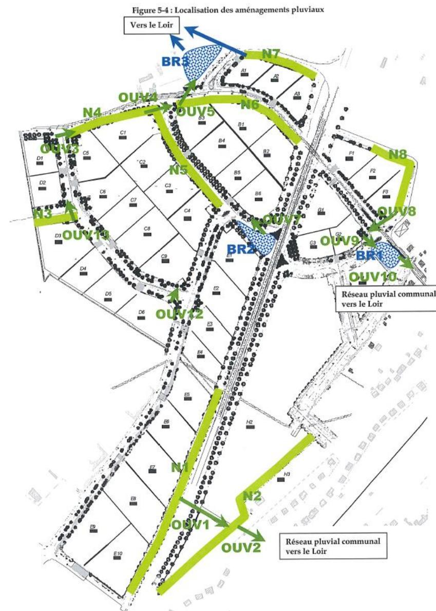
Figure 38 - Principe et ouvrages de gestion des eaux pluviales à l'échelle de la ZA (Source : DLE)
